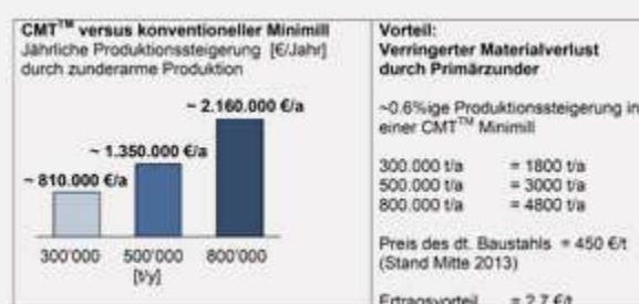
Bild 3: Jährliche Produktionssteigerung durch zunderarme Induktionstechnik in einer CMT™ Minimill (Quelle: SMS Concast)
