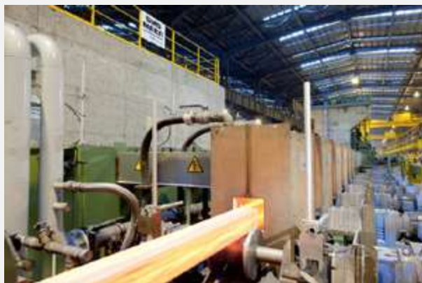
Bild 11: Knüppel vor der Wiedererwärmung am Einlauf der Elotherm EloHeat™ bei Tung Ho Steel in Taiwan (Werksbild SMS Elotherm)
