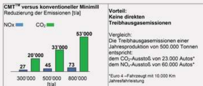
Bild 5: Die CMT™ Technologie mit integrierter induktiver Erwärmung reduziert die Emission von Treibhausgasen (Quelle: SMS Concast)
