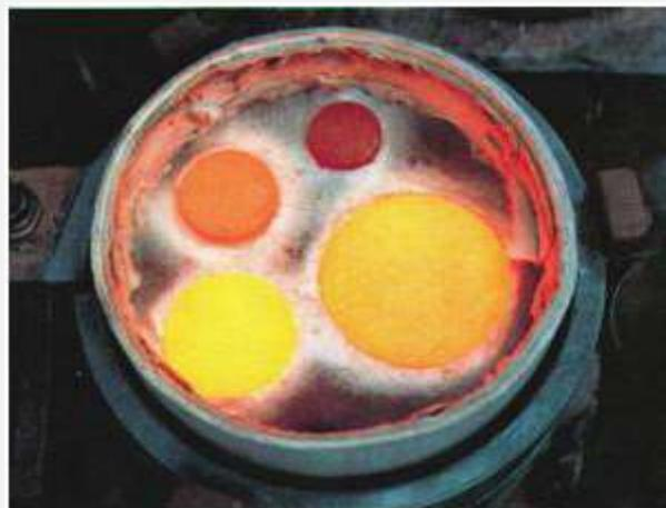
**Bild 5:** Unterschiedliche Erwärmung/Durchwärmung bei konstanter Frequenz und konstanten Werkstoffparametern in Abhängigkeit von der Werkstückgeometrie [7]
